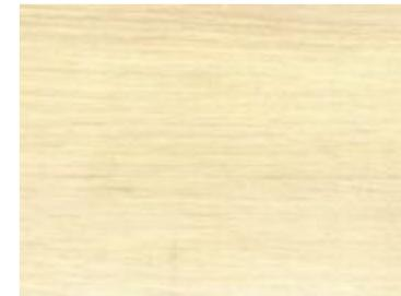
Hart, zäh, schwer, Markstrahlen als dunkle Streifen sichtbar. Für Werkzeug- und Maschinenbau.
