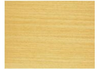
Welche Holzart?: Markstrahlen als Spiegel sichtbar, grosse Poren, cremefarben, mittelhart. Konstruktionsholz innen, Blindholz, Sperrholz.
