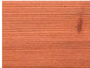
Welche Holzart?: Gute Witterungs- und Pilzbeständigkeit, Kern rotbraun, Stammdurchmesser bis 6 m. Konstruktionsholz für geringe Beanspruchung.
