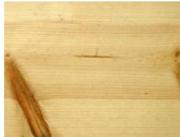
Welche Holzart?: Pilzanfällig, nicht witterungsbeständig, sichtbare Harzkanäle. Konstruktionsholz im Innenausbau für geringe Beanspruchung.
