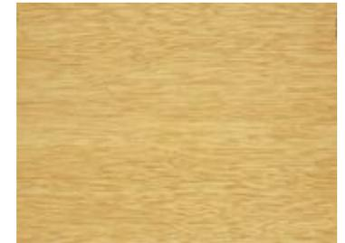
Welche Holzart?: Wechseldrehwüchsig, mässig hart, grosse, zerstreute Poren, leicht oliver Farbton. Konstruktionsholz für mittlere Beanspruchung, innen, Sperrholz.
