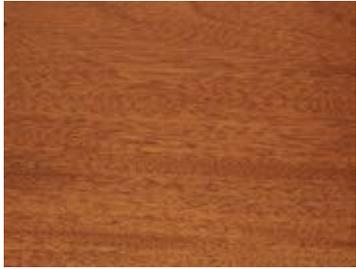
Welche Holzart?: Kernholz dauerhaft, rotbraun, schnell nachdunkelnd zu tief braunrot, schöner Glanz, mittelgrosse Poren, Wechseldrehwuchs. Innen- und Aussenbau, Möbel, Schiffe.
