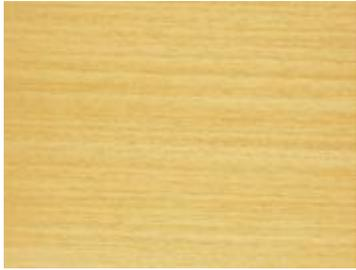
Markstrahlen als Spiegel sichtbar, grosse Poren, cremefarben, mittelhart. Konstruktionsholz innen, Blindholz, Sperrholz.
