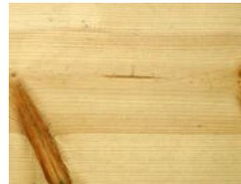
Pilzanfällig, nicht witterungsbeständig, sichtbare Harzkanäle. Konstruktionsholz im Innenausbau für geringe Beanspruchung.
