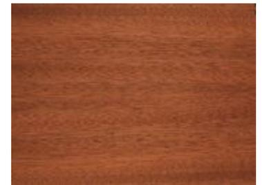
Kern rotbraun, Poren gross und zerstreut, Wechseldrehwuchs. Konstruktions- und Ausstattungsholz für mittlere Beanspruchung innen und aussen.
