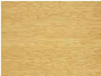
Wechseldrehwüchsig, mässig hart, grosse, zerstreute Poren, leicht oliver Farbton. Konstruktionsholz für mittlere Beanspruchung, innen, Sperrholz.
