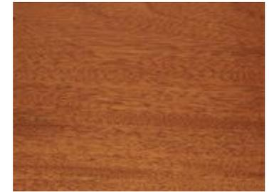
Kernholz dauerhaft, rotbraun, schnell nachdunkelnd zu tief braunrot, schöner Glanz, mittelgrosse Poren, Wechseldrehwuchs. Innen- und Aussenbau, Möbel, Schiffe.
