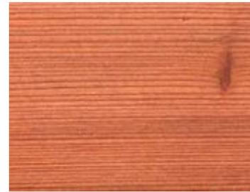
Gute Witterungs- und Pilzbeständigkeit, Kern rotbraun, Stammdurchmesser bis 6 m. Konstruktionsholz für geringe Beanspruchung.
