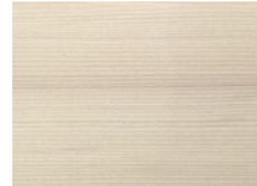
Welche Holzart?: Hell, z.T. violettschimmer, gut bearbeitbar und imprägnierbar, keine Harzkanäle. Für Möbel, imprägnierte Aussenverkleidungen.
