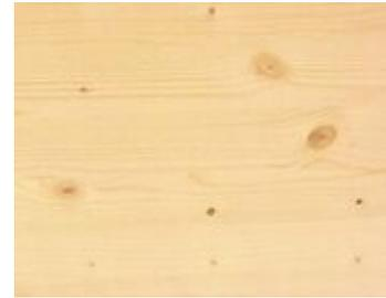
Hellgelblich, Seidenglanz, leicht aber tragfest, z.T. Harzgallen. Für Konstruktionsholz, Innenausbau.
