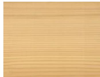
Hell, z.T. violettschimmer, gut bearbeitbar und imprägnierbar, keine Harzkanäle. Für Möbel, imprägnierte Aussenverkleidungen.
