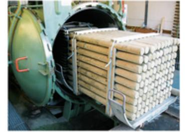
Die Hölzer werden in eine Vakuumkammer gelegt (Druckimprägnierung), damit das Holzschutzmittel tiefer eindringt oder gar eine Durchimprägnierung erreicht wird.
