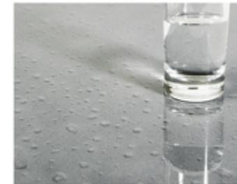
Mehrschichtiger farbig deckender Aufbau mit Polyurethanlack oder Wasserlack. Dabei sind verschiedene Spezialeffekte möglich. (Bild Effektlack mit Hochglanz)
