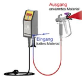
Das Spritzmaterial wird im Schlauch auf 20-60 °C erwärmt. Viskosität wird herabgesetzt (dünnflüssiger) und führt zur Verbesserung des Materialauftrags.
