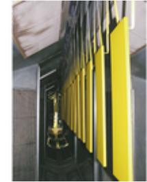
Sehr guter Umgriff, nahtloser Kantenverlauf, widerstandsfähig, keimfrei, kratzfest, umweltfreundlich da lösungsmittelfrei, überschüssiges Pulver wird abgesaugt und wiederverwendet.
