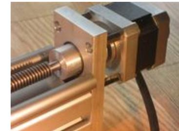
Einsatz als Vorschubmotoren bei CNC-Maschinen. Hohe Drehzahlen, präzise Steuerung.
