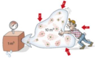
Welcher Druck entsteht, wenn die Luftmenge von 10 m<sup>3</sup> in einen Behälter von 1 m<sup>3</sup> gepresst wird?
