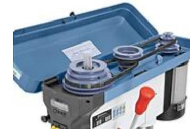
Die Reibung ist in den keilförmigen Rillen wesentlich stärker, das erlaubt eine höhere Kraftübertragung. "Herausspringen" wird durch seitliche Führung verhindert.
