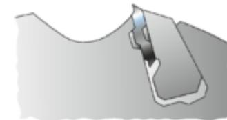
**Befestigung mit Spannschrauben** (Bild Frage) und **Fliehkraftspannung** (Bild).
