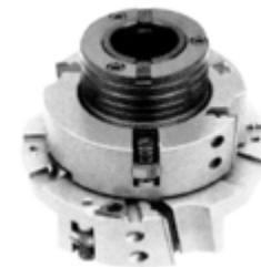
Er besteht aus **mehreren**, aufeinandergesteckten **Werkzeugen**. Damit können unterschiedliche Bearbeitungen **rationell** in einem Durchlauf ausgeführt werden. Bsp.: Fenster- und Türenfertigung.
