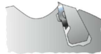
**Befestigung mit Spannschrauben** (Bild Frage) und **Fliehkraftspannung** (Bild).
