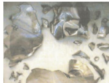
**Fliehkräfte**. Ein Überschreiten der zulässigen Drehzahl kann zu Werkzeugbruch mit fatalen Folgen führen. Bild: Zersprungenes Kreissägeblatt.
