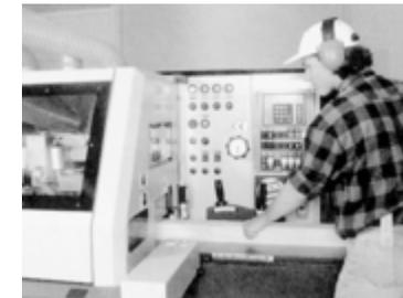
Das Werkstück wird durch die Maschine geführt: Kantenleimer, Vierseiten-Hobelmaschine.
