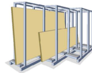
Stehend gelagerte Platten müssen immer vor dem Umfallen gesichert werden, auch bei kurzfristigen Zwischenlagerungen.
