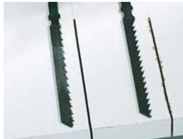
Links: Sägen auf **Stoss**, Werkzeugseitig ausrissfrei.
