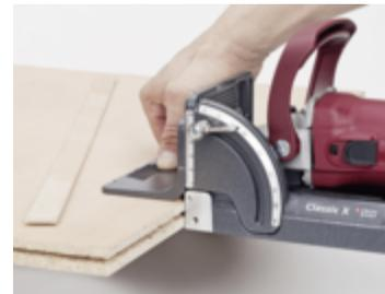
Nuten (Bild), Schattenfugen, Harzgallen-Flicke, Lamello- und Clamex-Verbindungen.
