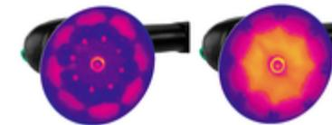
Links: **Gute Absaugleistung**, somit **geringere Erwärmung**, bessere Schleifleistung und Oberflächenqualität.
