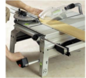
Eine portable Baukreissäge. Der Queranschlag bleibt fix und das Sägeblatt wird gegen das Werkstück bewegt.
