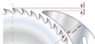
Beide Masse maximal 5 mm.
