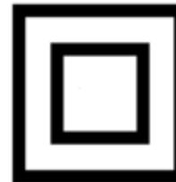
Schutzisolierung 2 (Sonderisolierung)
