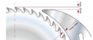
Beide Masse maximal 5 mm.
