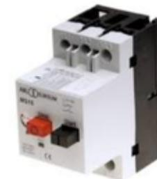
Der Maschinenschutzschalter löst bei Überlast/Überhitzung aus und unterbricht den Stromkreislauf, um den Motor zu schützen. Nach dem Abkühlen des Schalters kann die Maschine wieder gestartet werden.
