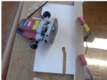
Der rechtsdrehende Fräser hat die Maschine vom Anschlag weggezogen. Die Nut müsste von der anderen Seite her gefräst werden oder die Anschlagleiste müsste links montiert werden.
