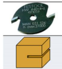
Der Nut-Scheibenfräser: auf diese Weise ist der Auflagetisch der Oberfräse auf der Fläche der Platte geführt (= grössere Auflagefläche) und das Werkzeug ist grösser (= grössere Schnittgeschwindigkeit).
