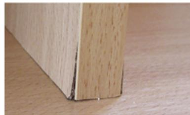
HWS sind nicht feuchtebeständig und quellen bei Wasserkontakt in der Dicke auf.
