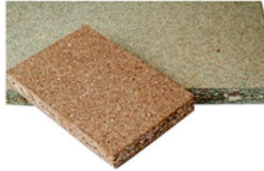
Grün eingefärbt: **Wasserfest** verleimte Spanplatten
