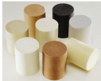
Schmelzklebstoffe kommen bei **Kantenleimmaschinen** und **Schmelzklebepistolen** in Granulatform (Bild Frage) oder Patronenform (Bild Antwort) vor.
