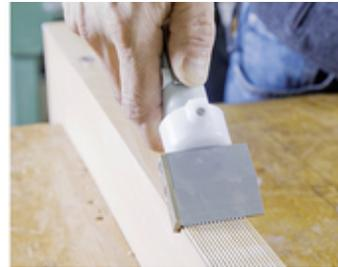
Weshalb muss nach dem Verkleben mit Dispersionsklebstoffen mit dem **Bündigfräsen** idealerweise eine Nacht **gewartet** werden?
