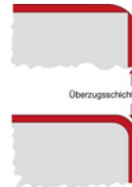
Damit sich die Schutzschicht darauf **optimal verteilen und haften** kann.
