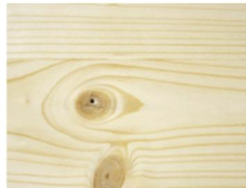
Harzgallen, lose Äste und Löcher müssen vor dem Schleifen ausgeflickt oder gespachtelt werden. Dellen müssen herausgedämpft werden.
