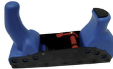
Für welche Arbeiten wird ein **Putzhobel** (Bild) und für welche ein **Simshobel** verwendet?
