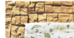
Die Braunfäule (Destruktionsfäule) zerstört die Zellulose. Das bräunliche Lignin bleibt zurück.
