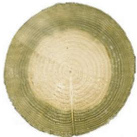
Pilzwidrige und insektenwidrige chemische Wirkstoffe werden ins Holz gebracht, welche ein Eindringen von Insekten und ein Wachsen von Pilzen verhindern.
