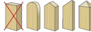
Ein gerader Schnitt ohne Schutz führt zu leichterem Eindringen der Nässe in das Stirnholz. Regel: Wasser die Möglichkeit geben, abfließen zu können.
