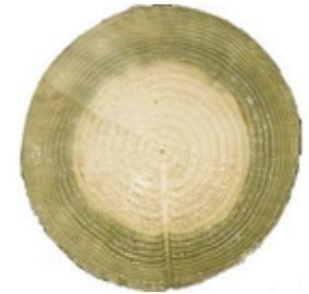
Pilzwidrige und insektenwidrige chemische Wirkstoffe werden ins Holz gebracht, welche ein Eindringen von Insekten und ein Wachsen von Pilzen verhindern.
