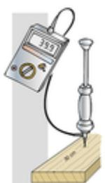
Mit einem **Holz-Feuchtemessgerät**.
