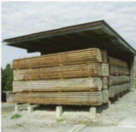
Holzbretter werden mit Abstandleisten, vor Witterung geschützt, an luftigem Ort gestapelt. Luft zirkuliert und entzieht dem Holz Feuchtigkeit = Trocknung.
