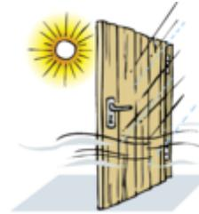
**UV-Strahlung:** führt zum Abbau von Lignin und Inhaltsstoffen.
