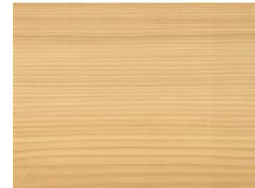
Hell, z.T. violettschimmer, gut bearbeitbar und imprägnierbar, keine Harzkanäle. Für Möbel, imprägnierte Aussenverkleidungen.
