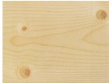
Welche Holzart?: Hellgelblich, Seidenglanz, leicht aber tragfest, z.T. Harzgallen. Für Konstruktionsholz, Innenausbau.
