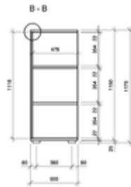
Die Frontal-, Vertikal- und Horizontalschnitte zeigen das Schreinerprodukt, wenn es aufgeschnitten wird. So werden Teile im Innern sichtbar.
