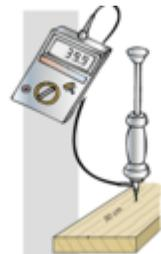
Elektroden werden auf das Holz aufgedrückt oder eingeschlagen. Der zwischen den Elektroden fließende Strom wird gemessen. Er hängt ab von der Holzfeuchtigkeit und der Holzart.
