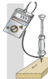
Elektroden werden auf das Holz aufgedrückt oder eingeschlagen.
