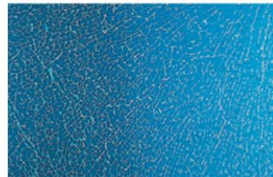
**Einscheibensicherheits-Glas** ist belastbarer als normales Glas und bietet Schutz vor Verletzungen. ESG ist vorgespanntes (sekurisiertes) Glas, das erhitzt und anschließend mit kühler Luft abgeschreckt wird.
