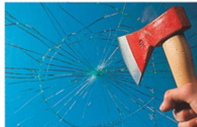
**Verbundsicherheits-Glas** bietet Schutz vor Einbrüchen und Durchbrüchen. Besteht aus zwei oder mehreren Glasscheiben, welche mit einer zähen, transparenten Kunststoffolie miteinander verbunden werden.
