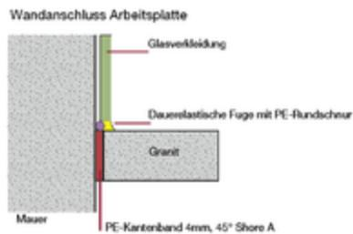
Mit einem PE-Kantenband, das zwischen die Arbeitsplatte und die Wand geklebt wird.
