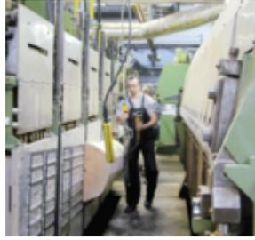
Beim Messerfurnierverfahren werden quer zur Faserrichtung des Stammes mit einem Messer handhobelähnlich Furniere abgetrennt. Dabei wird das Holz am feststehenden Messer vorbeigeführt.
