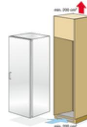
**200 cm<sup>2</sup>** Lüftungsquerschnitt innerhalb der Gerätebreite unten und oben.
