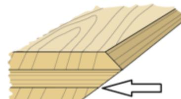
Leimfuge, die an einer flachen Fase oder auslaufenden Rundung als breite Linie sichtbar ist.
