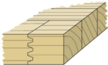
Typ **NC** (No Cuts), einzelne Stäbe in der Länge ungeteilt (s. Bild Frage).
