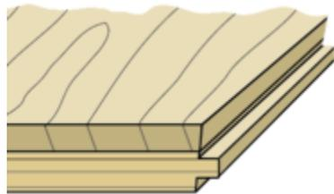
**2-Schichtparkett** (Bild): Verklebung auf Unterlagsboden, Fugen werden nicht verklebt.
