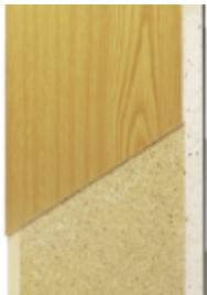
Mittellage aus Spanplatten, Decklage meist Faserplatten.
