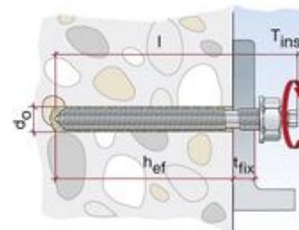
**Mörtelpatrone und Gewindestange eines Reaktionsankers.**
