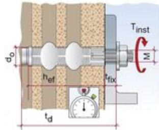
**Kunststoffhülle und Gewindestange eines Injektionsankers.**
