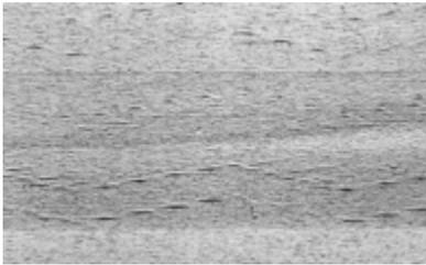
Was ist die Ursache dieser nadelstreifenartigen Erscheinungen auf einer Fläche, die mit der Breitbandschleifmaschine geschliffen wurde?
