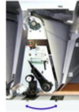
Welches sind Vorteile des Diagonalschliffs bei der Breitbandschleifmaschine? Dabei ist das Schleifaggregat leicht schräg in der Maschine montiert.
