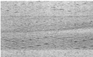
Kornausbruch im Schleifband, verursacht durch einen Fremdkörper (Äste, Schmutz) im Schleifgut.
