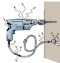
Bei Werkzeugwechsel Stecker ausziehen; keine Maschinen mit defekten Kabeln und Steckern verwenden; Maschine nur im Stillstand ablegen; Werkstücke bei der Bearbeitung fixieren; PSA und FI-Schalter einsetzen
