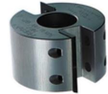
Die Schneiden sind parallel zur Werkzeugdrehachse angeordnet.
